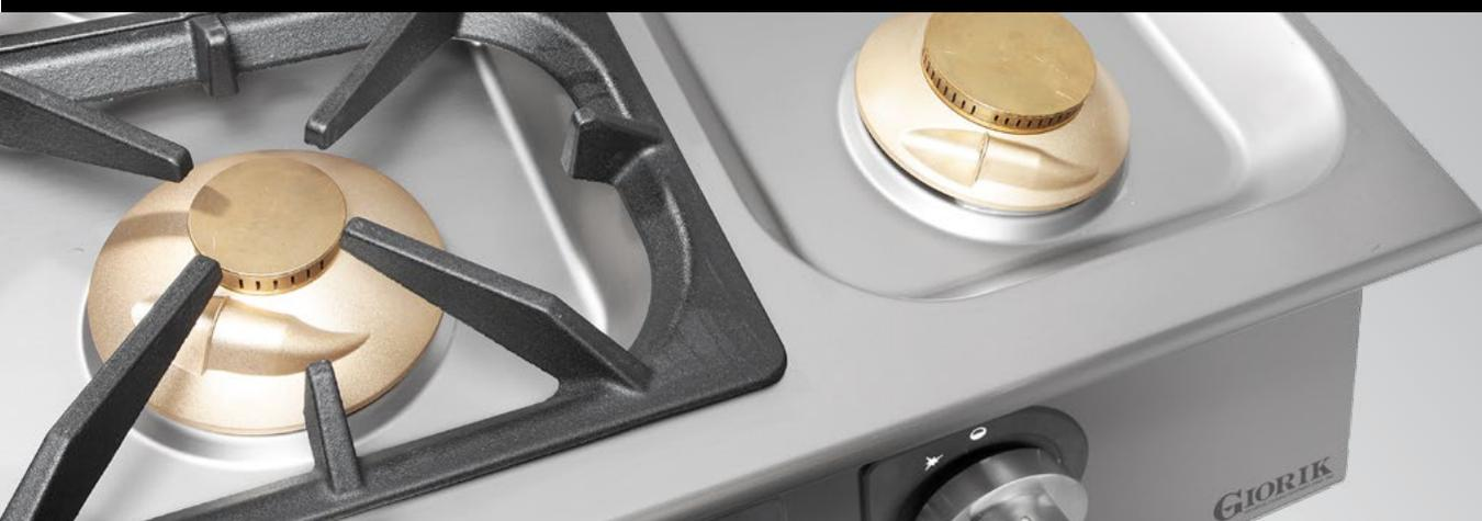
**IT** | Bruciatori in ottone con potenze variabili da 4-8 kW. Il piano di cottura ricavato da profondo stampaggio con bruciatori in ottone fissati ermeticamente al piano stesso, evita la traccimazione di qualsiasi liquido e ne facilita la pulizia.
